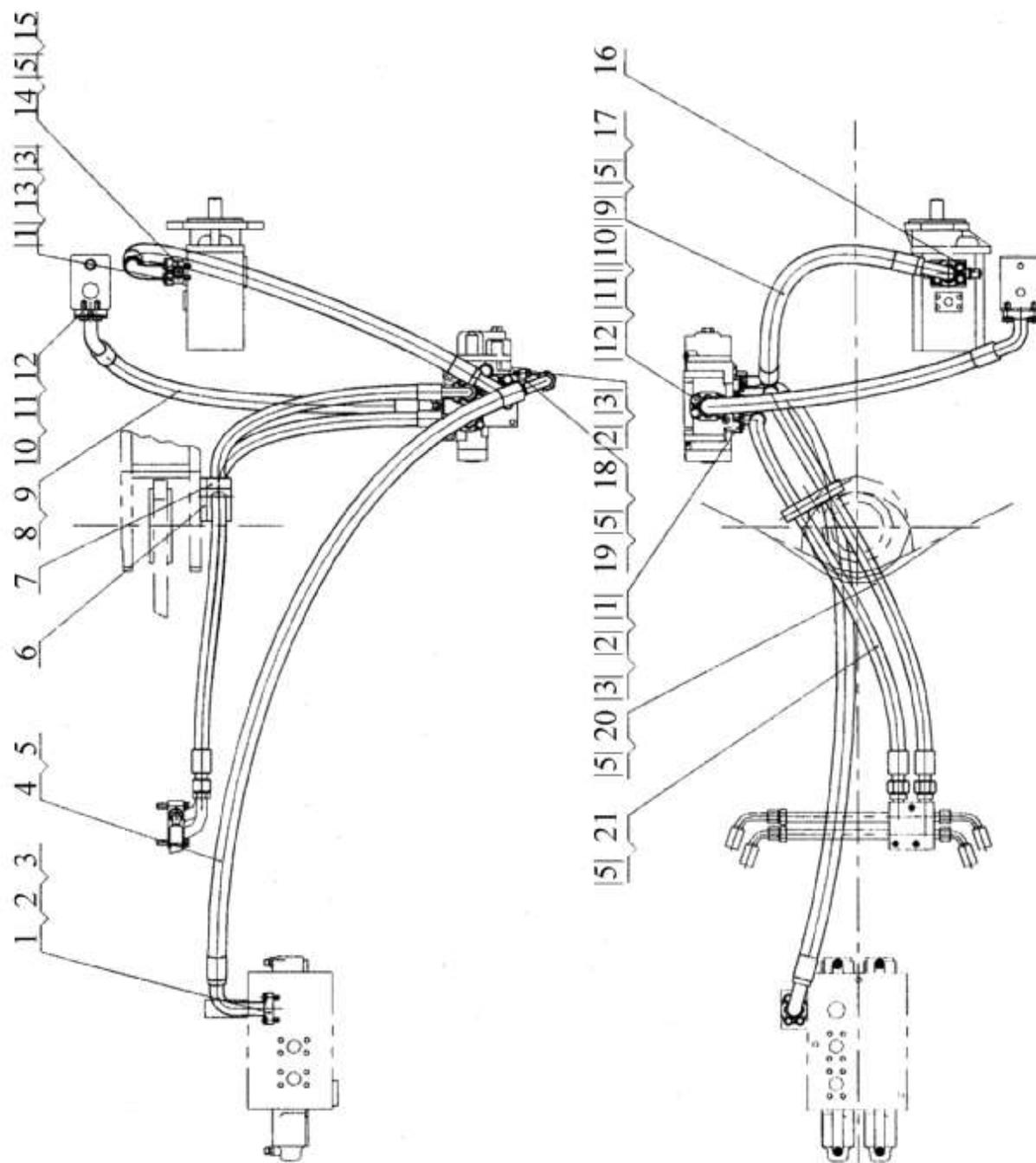
**00С0209 Трубопровод блока клапана**
