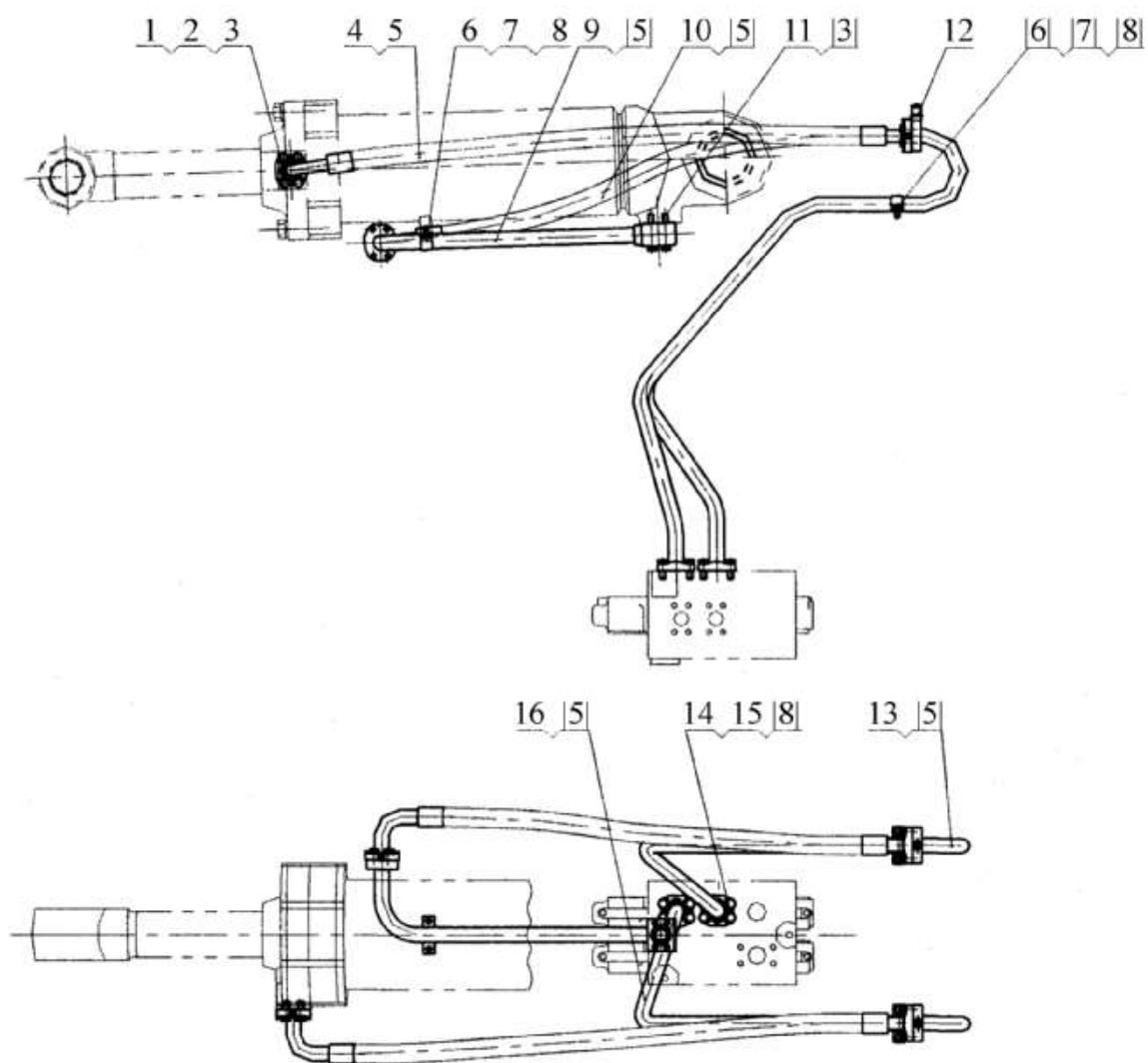
**00C0207 Трубопровод гидроцилиндра опрокидывания**
