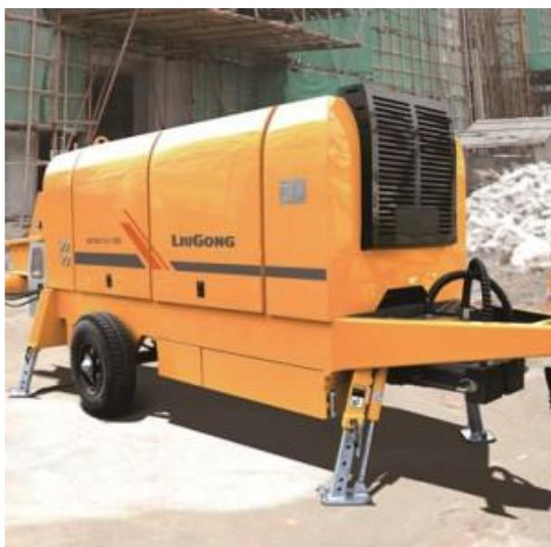
Специальная дорожно-строительная техника Liugong, передвижной бетононасос HBT85-15-174S с мощностью двигателя 174 kW, макс. производительностью бетона 85/50 м³/ч предназначен для строительных работ на любой местности.
