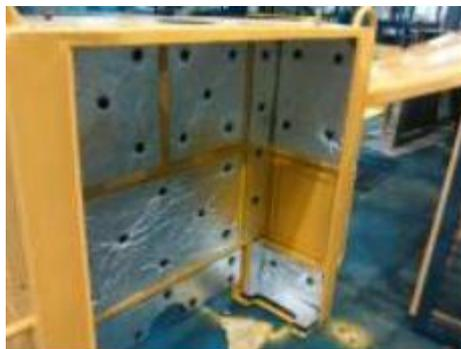
Улучшенная звукоизоляция кабины, снижает шумность внутри кабины до 1 Дб
