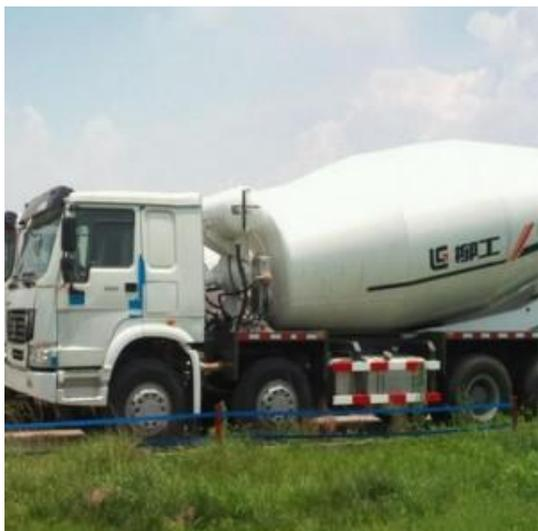
Специальная дорожно-строительная техника Liugong, автобетоносмеситель YZH5311GJBHW с мощностью двигателя 247 kW, объемом смесительного барабана 21.9 м<sup>3</sup>, гидронасосом USA Sauer объемом гидравлического бака 20 L предназначен для строительных работ на любой местности.
