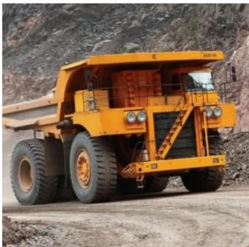
Специальная дорожно-строительная техника Liugong, карьерный самосвал SGE190AC с грузоподъемностью 172,000 kg, максимальной скоростью 40 km/h предназначен для строительных работ на любой местности.
