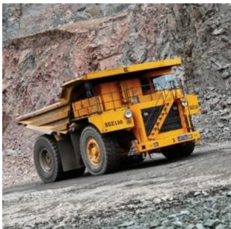
Специальная дорожно-строительная техника Liugong, карьерный самосвал SGE150 с грузопъемностью 136,000 kg, максимальной скоростью 40 km/h предназначен для строительных работ на любой местности.
