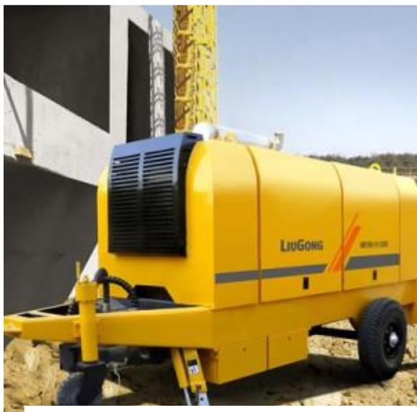
Специальная дорожно-строительная техника LiuGong, передвижной бетононасос HBT60-13-132S с мощностью двигателя 132 kW, макс. производительностью бетона 63 м<sup>3</sup>/ч предназначен для строительных работ на любой местности.
