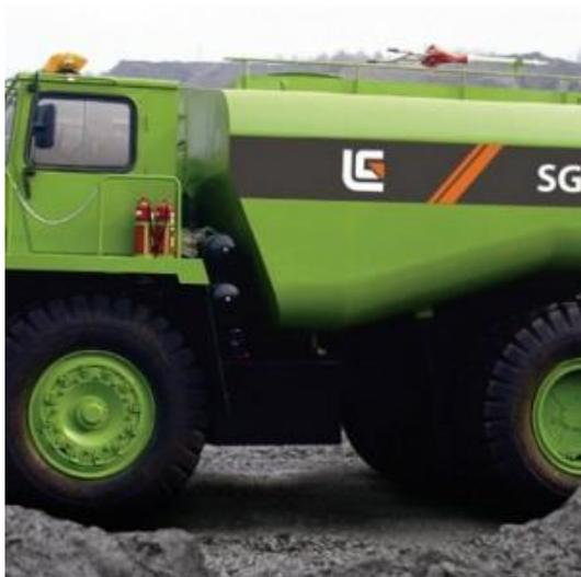
Специальная дорожно-строительная техника Liugong, карьерная поливочная машина SGA5650 с емкостью резервуара 40 m<sup>3</sup>, напором водомета 40 m, шириной полива 16 m, максимальной скоростью 56 km/h предназначен для строительных работ на любой местности.
