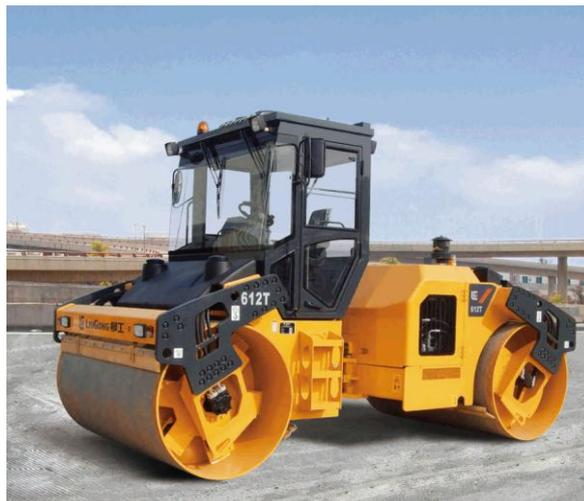
Каток массой 12,4 т со сдвоенным рулевым управлением. Система смещения колеи переднего и заднего вальца на 200 мм влево и вправо дает возможность перемещения крабовым ходом.
