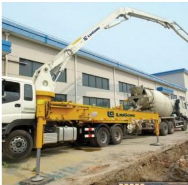
Специальная дорожно-строительная техника Liugong, бетононасос-кран HDL5270THB с мощностью двигателя 265 kW, макс. производительностью бетона 120 м³/ч, максимальной подачей по вертикали 36.8 м, максимальной подачей по горизонтали 32.8 м предназначен для строительных работ на любой местности.
