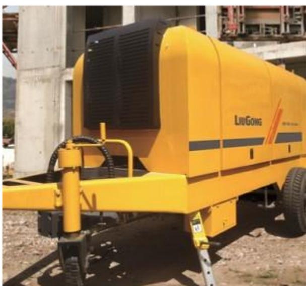
Специальная дорожно-строительная техника Liugong, передвижной бетононасос HBT80-18-195 с мощностью двигателя 195 kW, макс. производительностью бетона 80/50м<sup>3</sup>/ч предназначен для строительных работ на любой местности.
